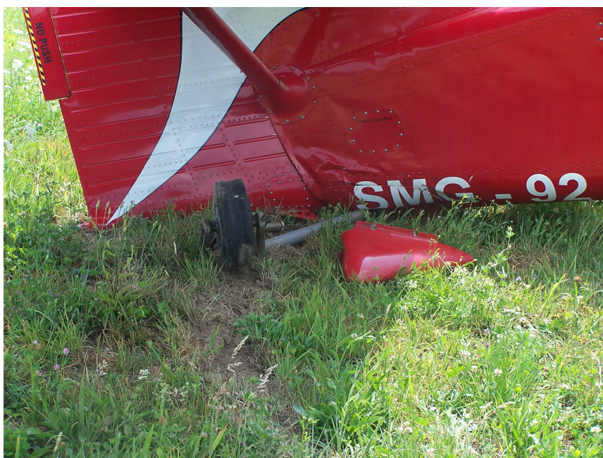
3.kép: A sérült farokfutó
