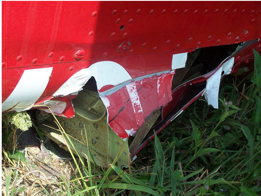
6.kép: A törzs hátsó-alsó rész sérülése
