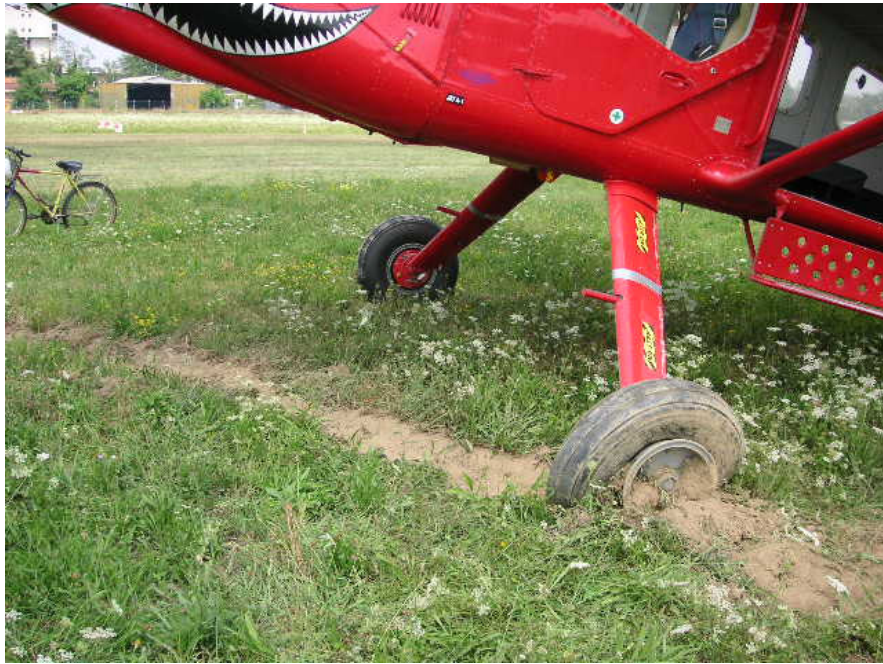
5.kép: A bal kerékről legyűrődött gumiabroncs
