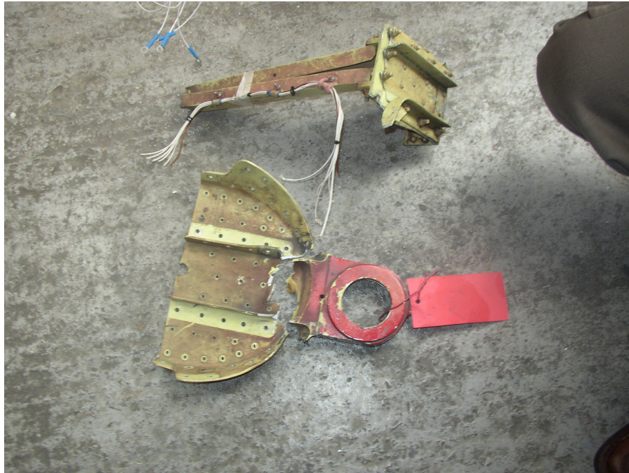
7.kép: A farokfutó bekötés és kivezetés törzsben lévő sérült szerkezeti elemei (szétbontás után)
