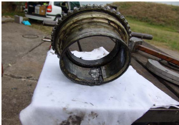
A tengelytámaszról és a retesz elnyíródásáról készült kép.
