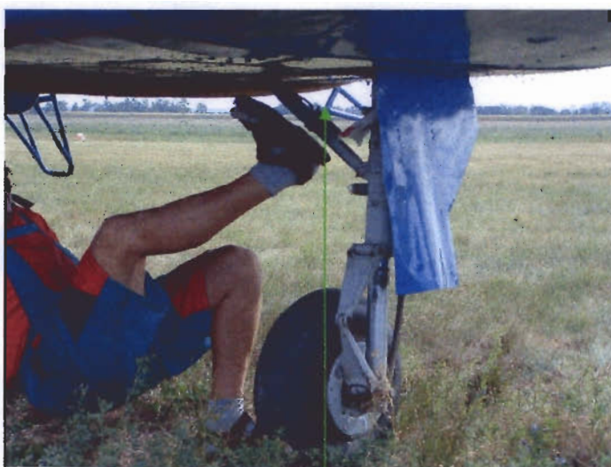
kinematikai zár zárása a szárny felemelt állapotában
