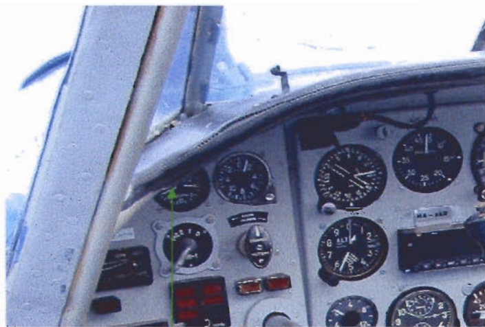
levegő rendszer kétmutatós nyomásmérője
