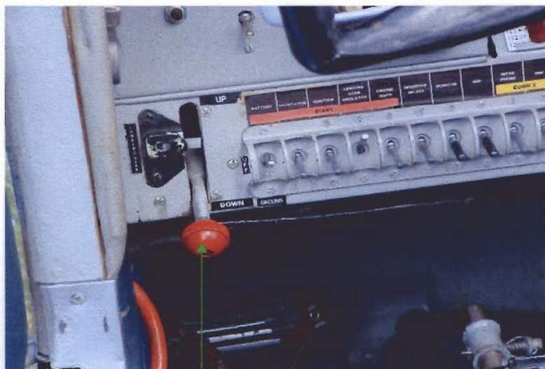
futómű működtető csap vezérlő karja
