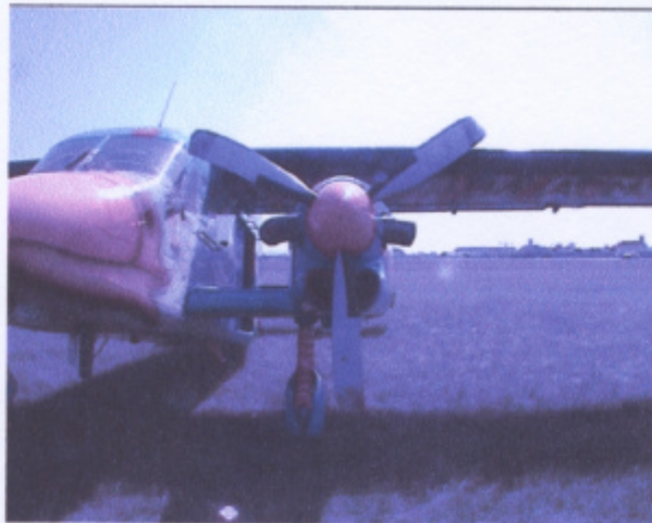
1.kép A sérült bal oldali légcsavar
