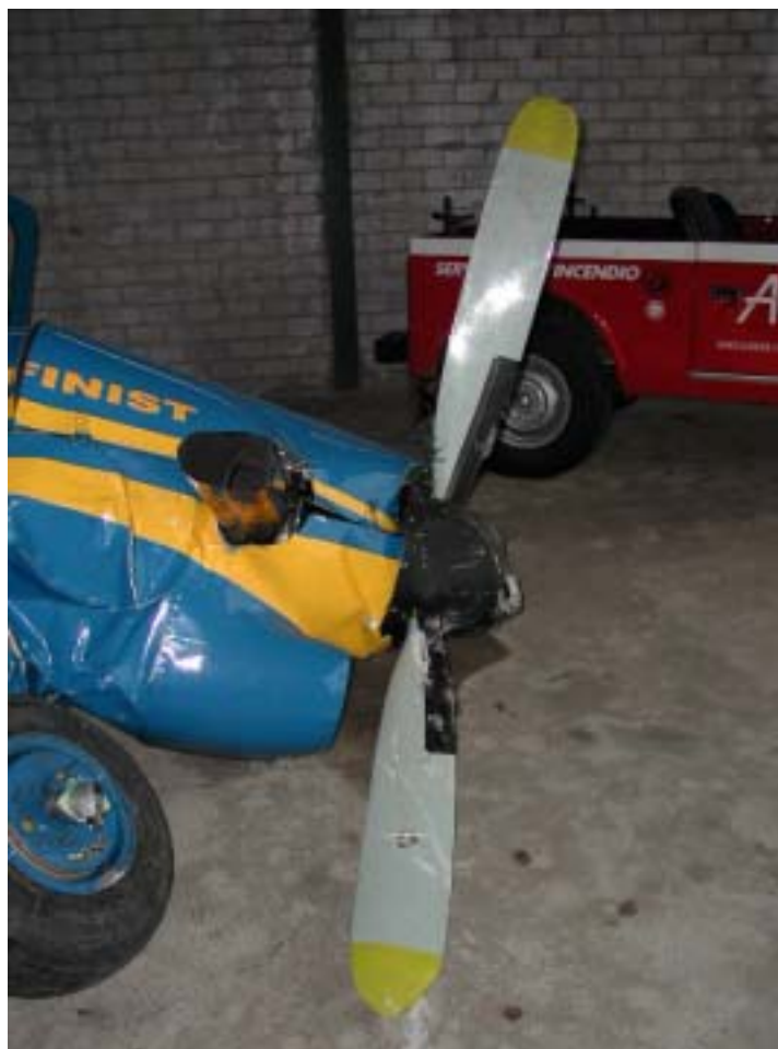
Ogiva ed elica. Non vi sono danni dovuti ad effetti di torsione - rotazione
