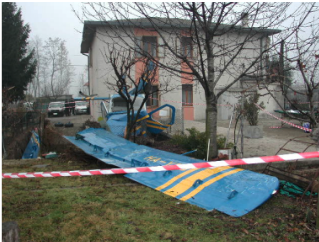
Semiala sinistra che si è staccata dal corpo fusoliera
