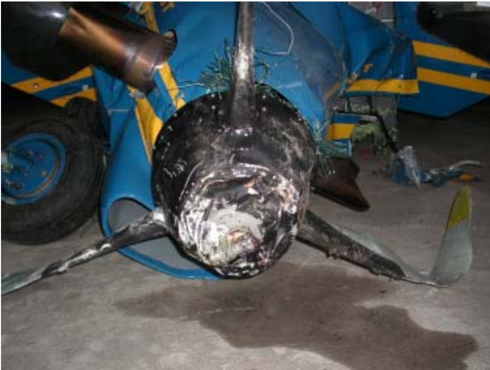
Ogiva ed elica. Non vi sono danni dovuti ad effetti di torsione - rotazione
