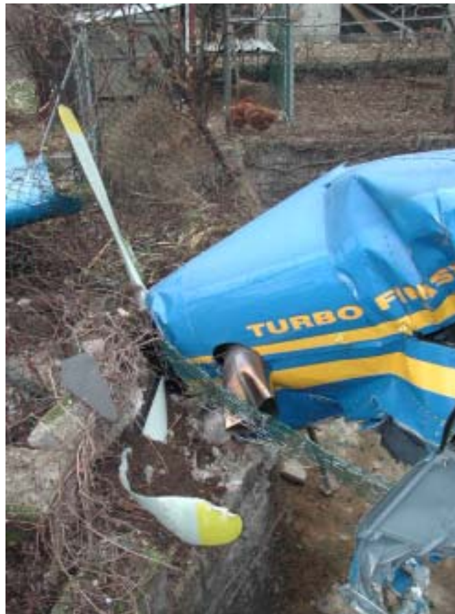
Danni al muso del velivolo. Non vi sono particolari danni alle estremità dell'elica
