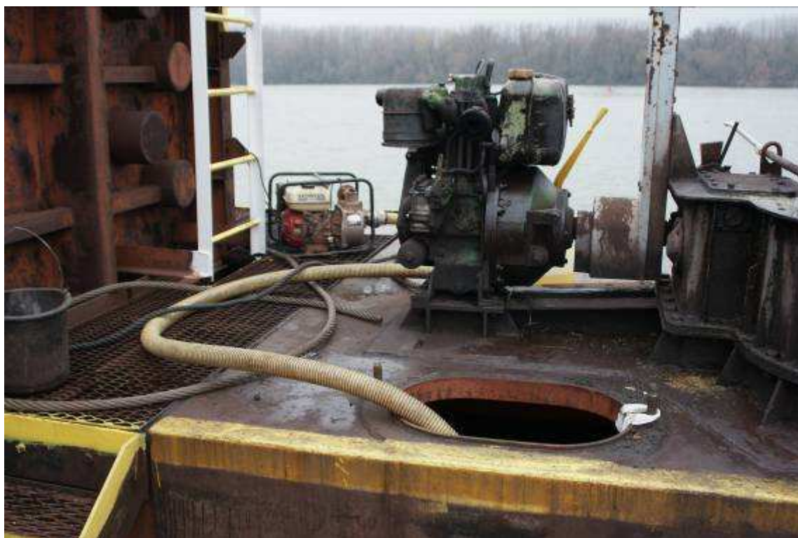
3-4. fénykép: Víz szivattyúzása a bárkából.
