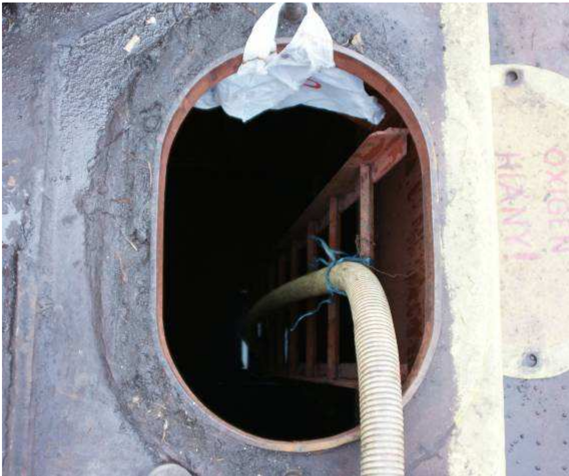
3-4. fénykép: Víz szivattyúzása a bárkából.
