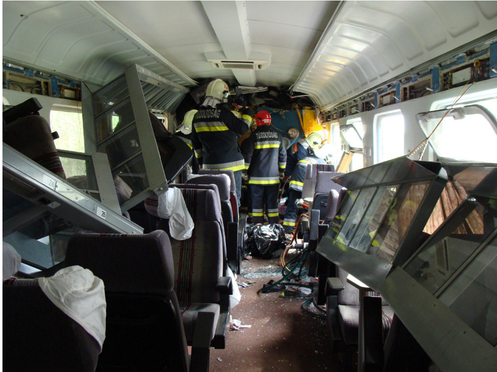
5. ábra: az IC 560-1 sz. vonat utolsó kocsijának belső tere a leszakadt csomagtartókkal
