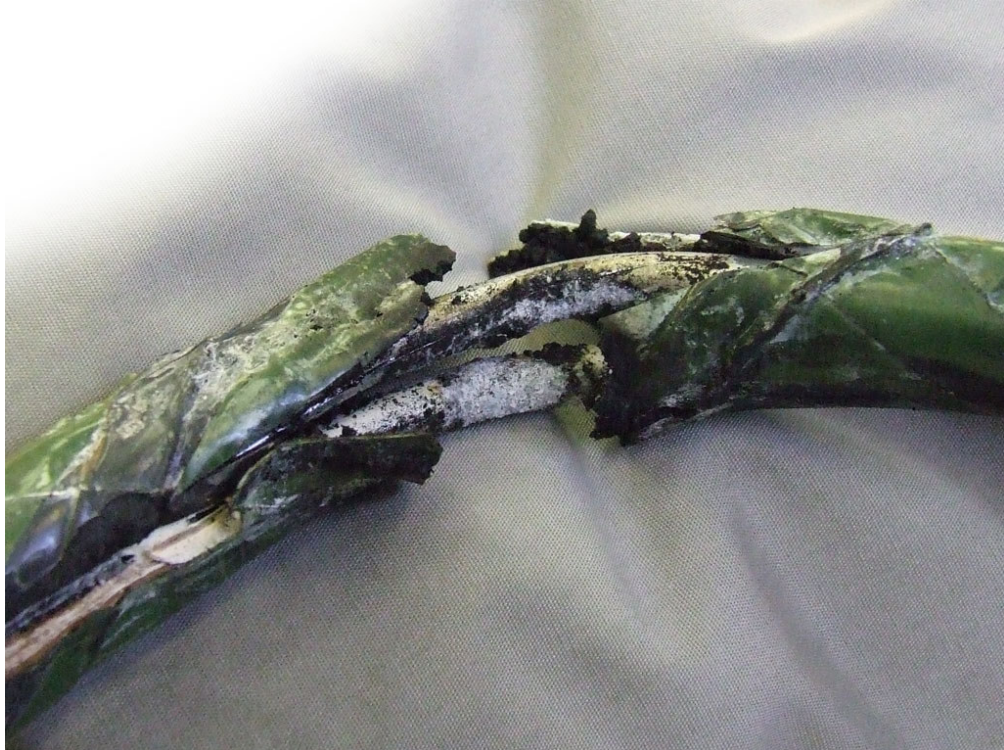
20. ábra: a megbontott kábel zárlatba került erei és a megégett szigetelés
