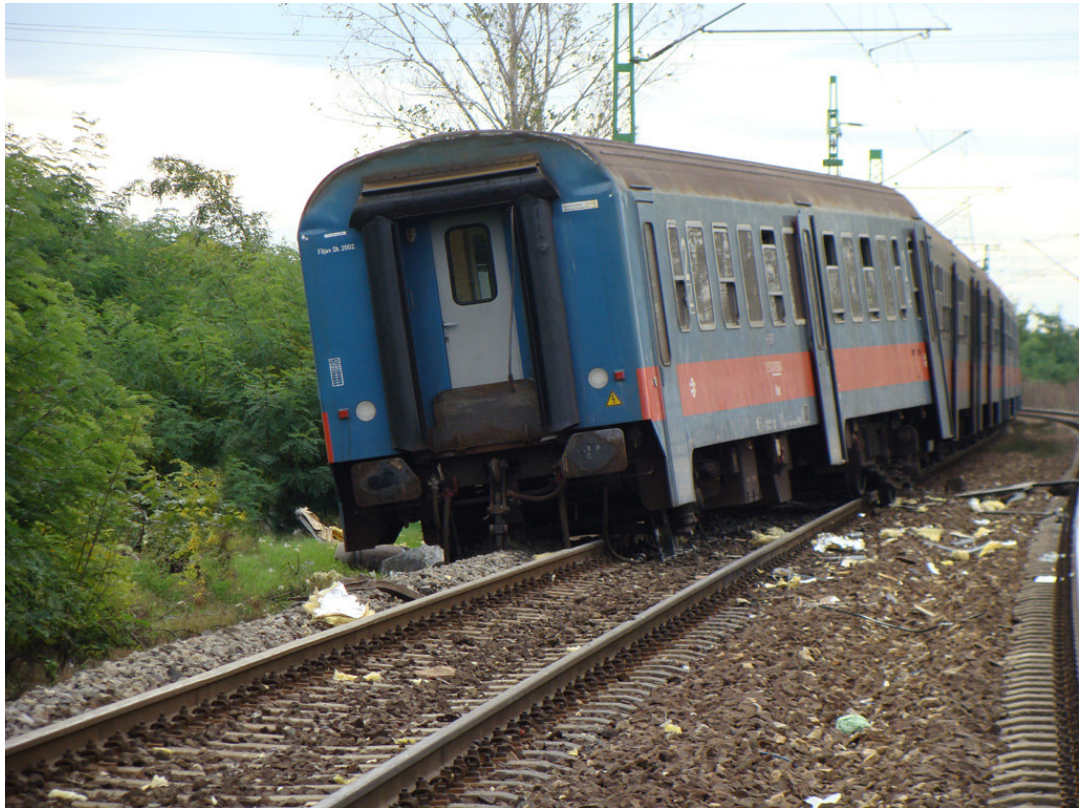
6. ábra: a személyvonat kisiklott második kocsija és az elszóródott roncsok egy része
