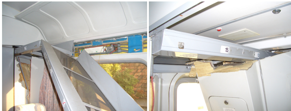
25. ábra: a WC falát átszakító csomagtartó-elem, a fal mindkét oldaláról
