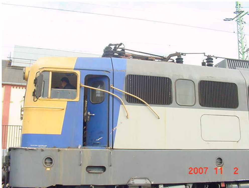
4. ábra: a vontatójármű sérülése az első (2007-398-5) balesetben (Fotó: MAV Zrt.)
