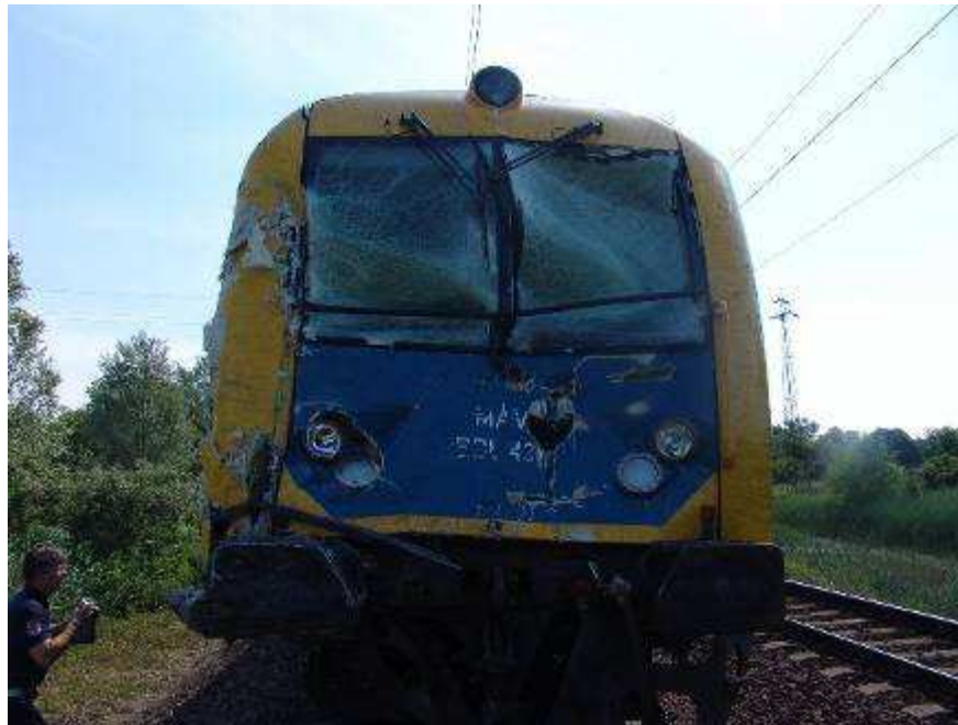
3. ábra. A megsérült vezérlőkocsi
