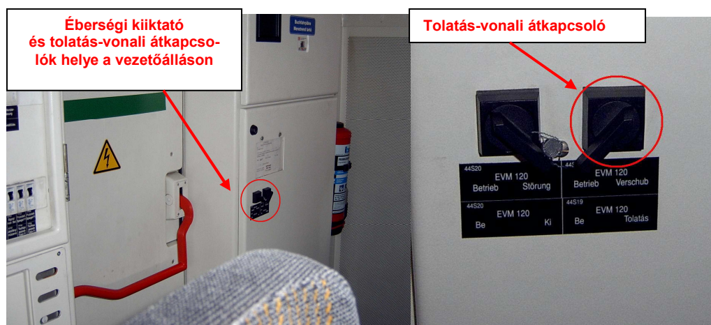
8. ábra: Tolatási-vonali kapcsoló elhelyezése a mozdony vezetőállásán
