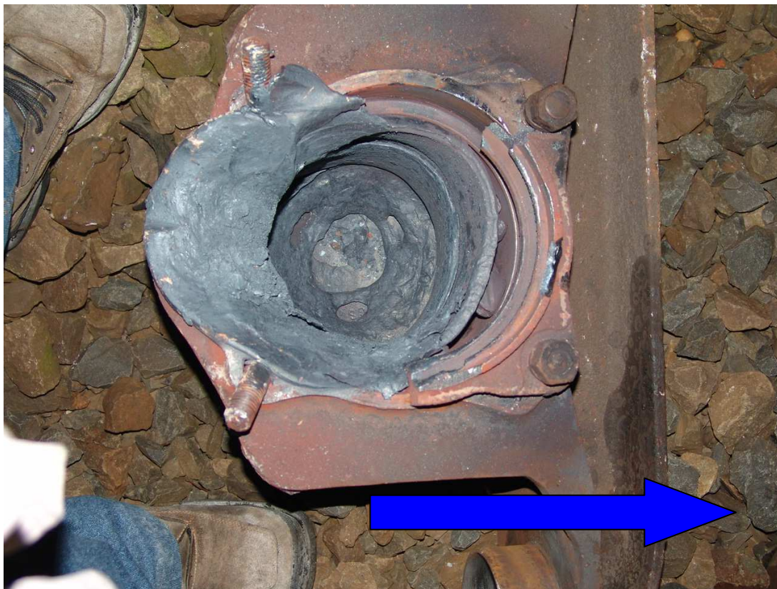
5. ábra: Kiolvadt csapágyház (a két vágány között) az 1658+85 számú szelvényben
