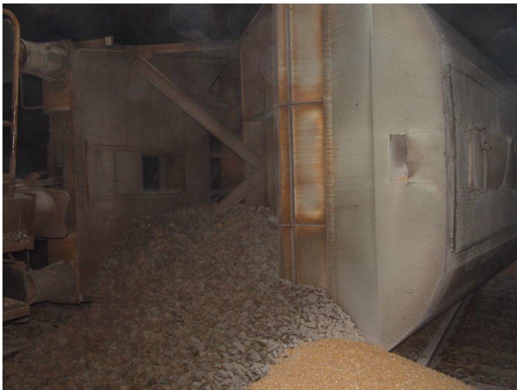
3. ábra: A bal oldalára dőlt siklott 33 87 933 4530-1 pályaszámú teherkocsi
