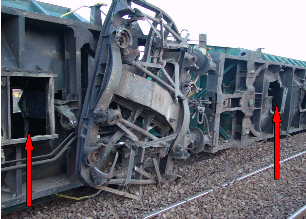
13. sz. ábra: a borult kocsik ürítő nyílásai, fedél nélkül
