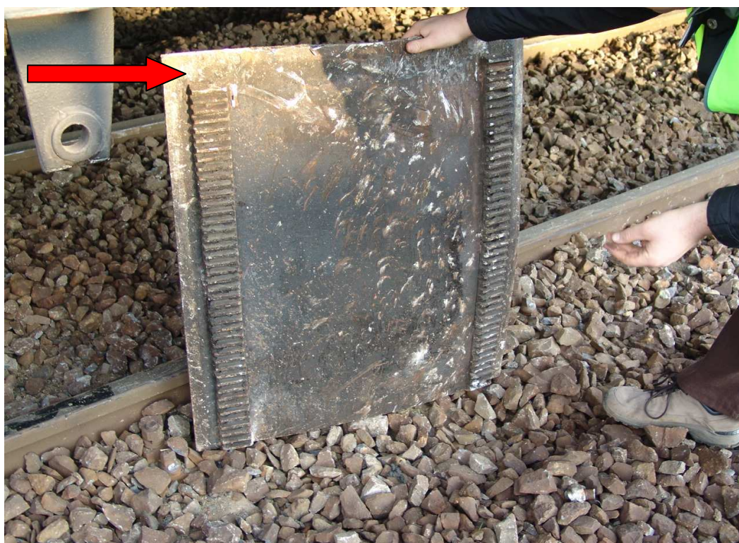
12. ábra: Ebes állomáson megtalált biztosítás nélküli ürítő lemez.
