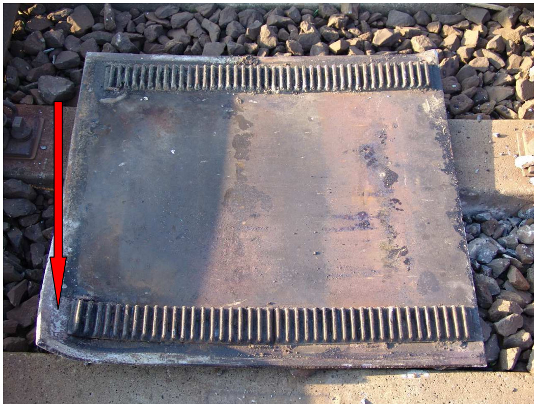
5. ábra: a nyíltvonalon megtalált biztosítás nélküli ürítő lemez
