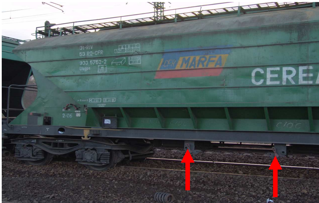
9. ábra: nyitás-zárás szabályozása a kocsi mellől áttétellel
