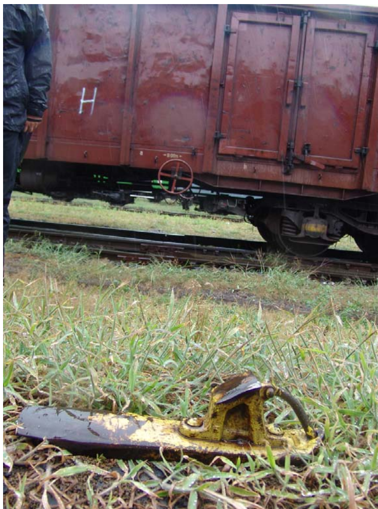
8. ábra: A balesetet okozó féksaru, mely az első kocsi alatt maradt
