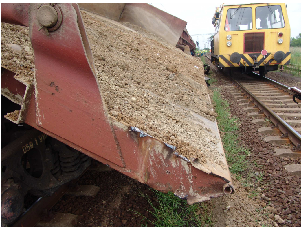
4. ábra: Az oldalra billent kocsiszekrény lenyíló ajtaja kismértékben sérült
