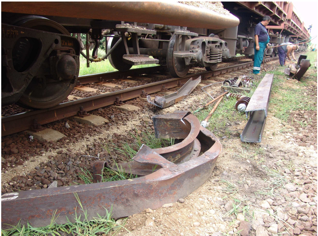
6. ábra: A kidöntött és megrongálódott felsővezetési tartóoszlopok
