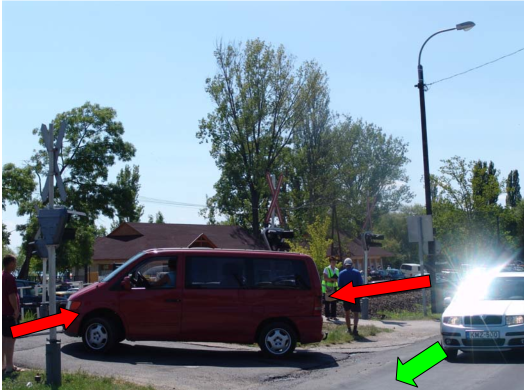
25. ábra: A fényjelzőt meghaladó és az úrszelvényben megálló gépjárművet a közlekedő vonat elérheti
