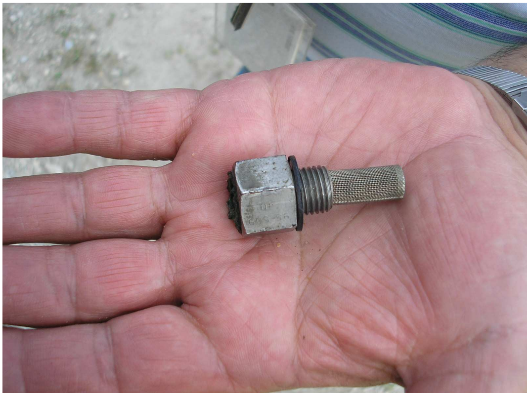
A kiszertelt szűrő fémhálója. A szennyeződés a hálón belül van.
