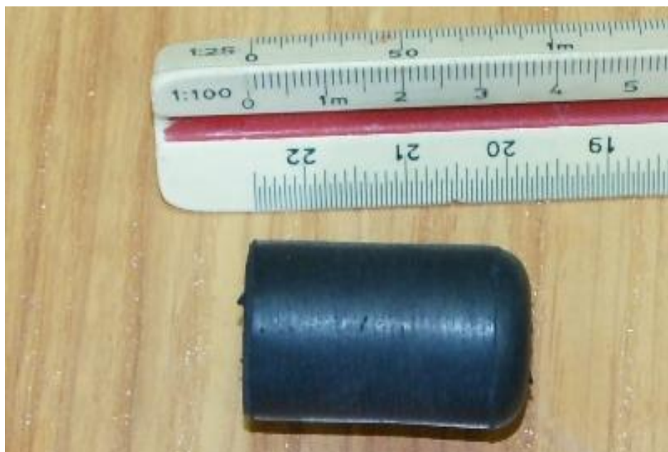
6. ábra: A leköszörült, cserélt gumitömb a bal futóműből.
