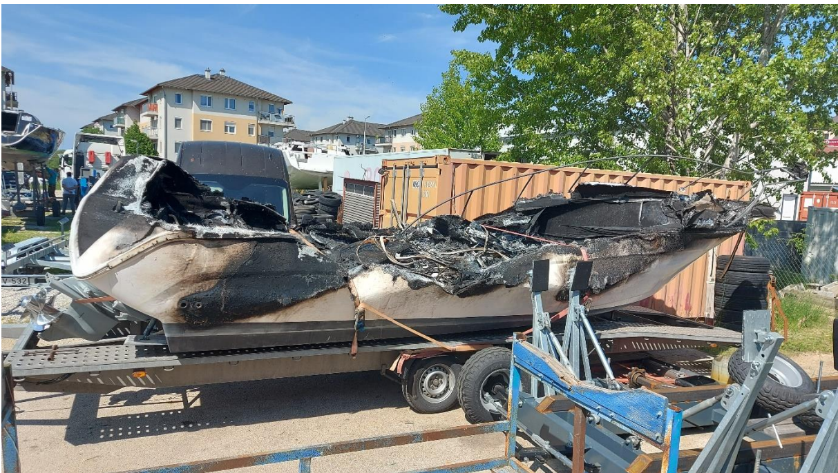
4. ábra: A balesetben leégett kisgéphajó roncsa vízből kiemelt állapotban.
