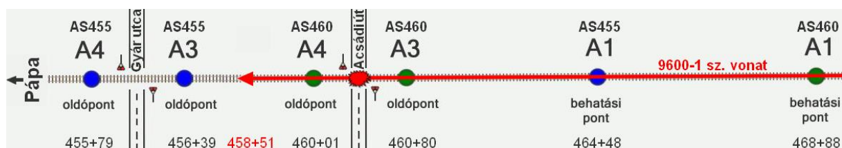
1. ábra: a sorompók vonatérzékelési pontjainak elhelyezkedése
