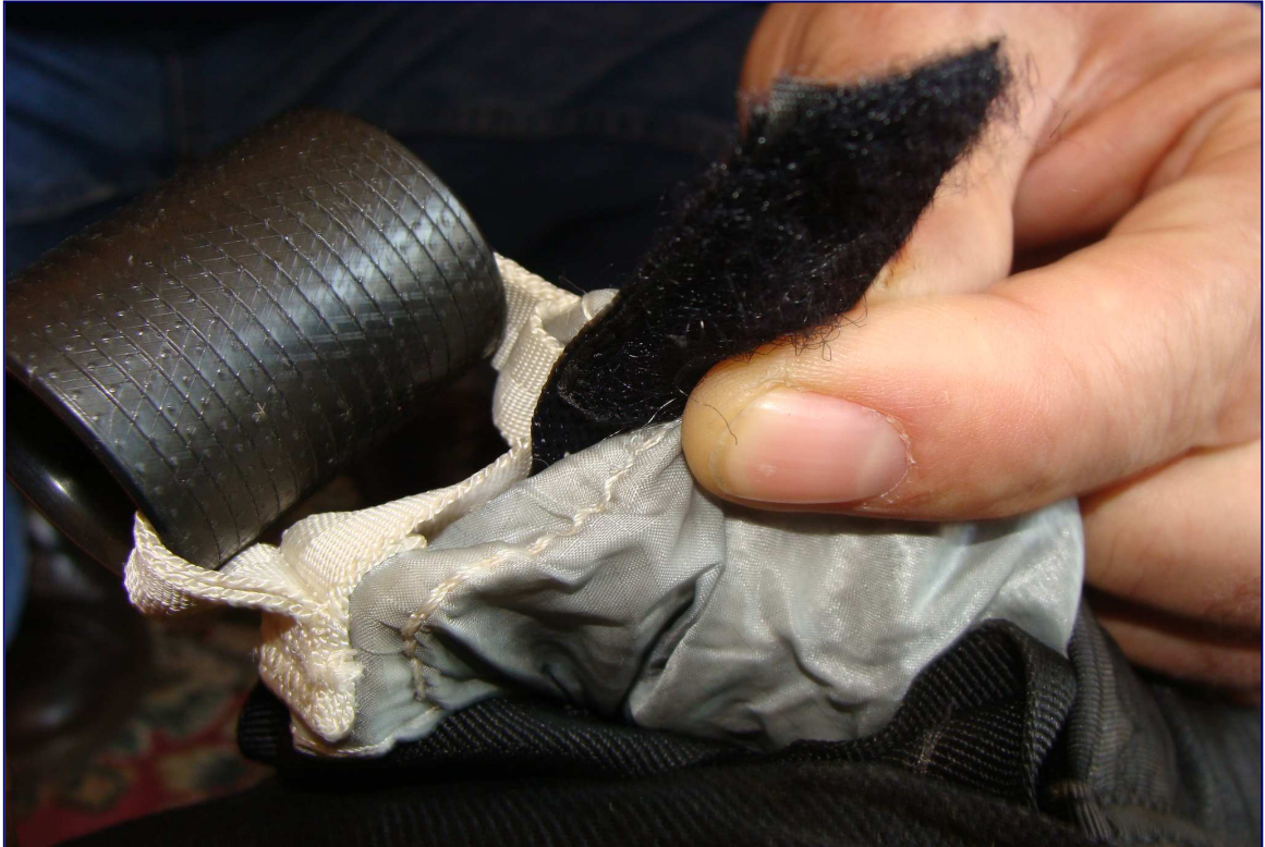
3. sz. kép: A nyitóernyő fogantyúján előtalált tépőzár darab
