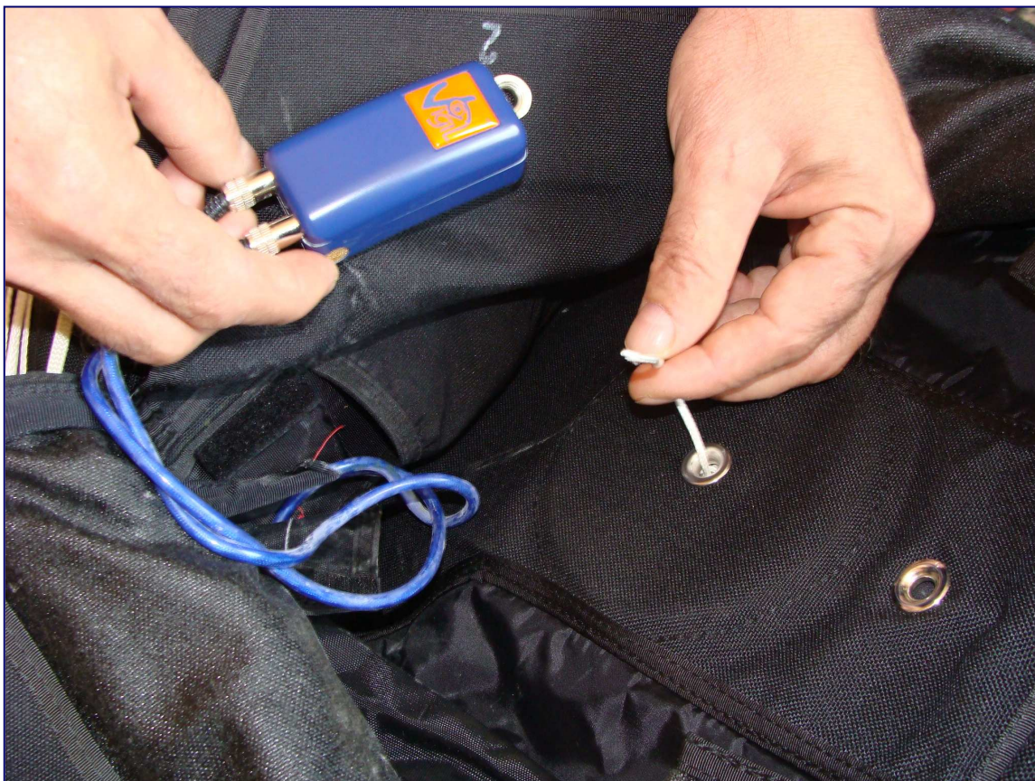
4. sz. kép Az elektronikus nyitókészülék az elvágott lezáró hurokkal
