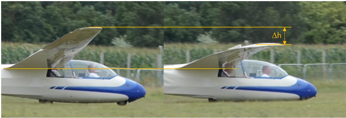
7. ábra: a szárny a földet éréskor a nagy erő hatására lengőmozgást végez
