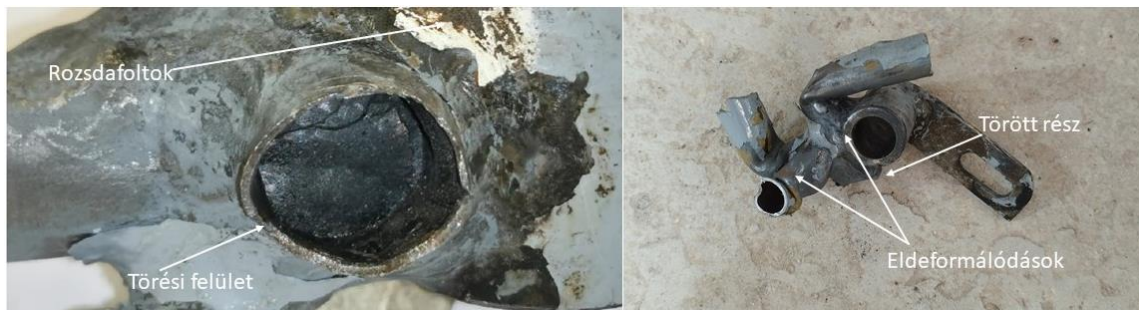
4. ábra: A futómű-bekötés sérülései
