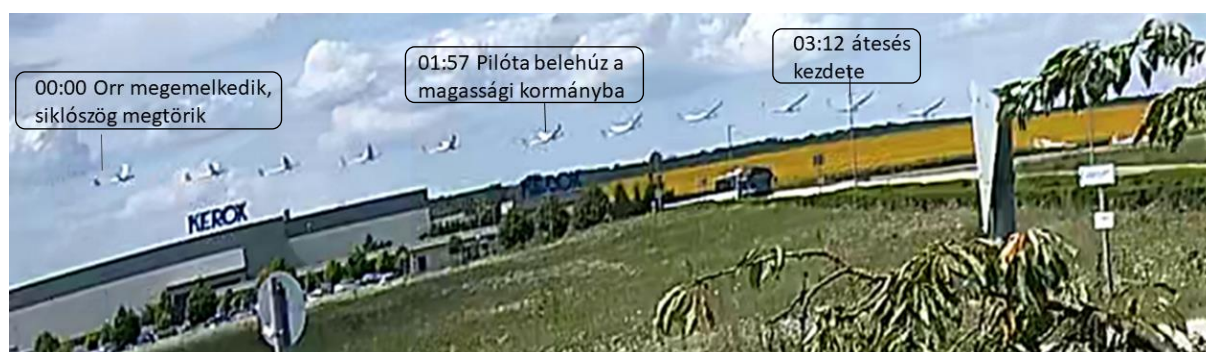
5. ábra: a légi jármű végső megközelítésének rekonstrukciója az egyik térfigyelő kamerafelvétel alapján. (A képen az idő mp:mp formátumban kerül jelölésre, ahol az első szám az eltelt másodpercet, a második szám pedig annak hatvanad részét jelzi.)
