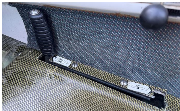
3. ábra: a főfutómű kezelőszerve
