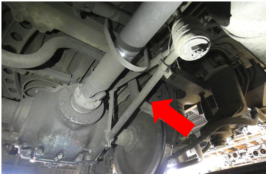
3. ábra: egy üzemszerűen kialakított nyomatéktám
