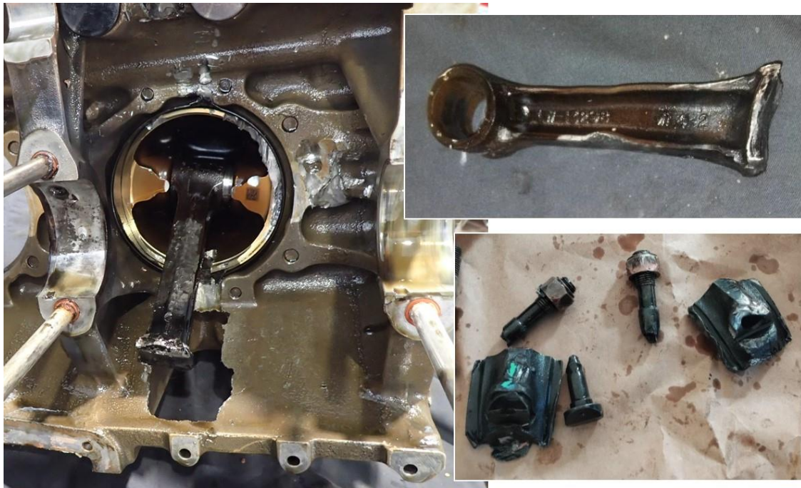
2. ábra Az eseményben érintett motorban meghibásodott hajtókar-csavarok, hajtókar, forgattyúház.
