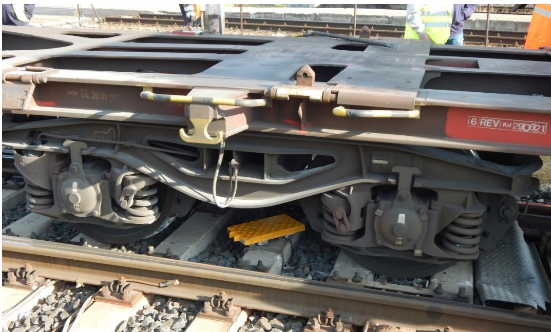
5. ábra: a kisiklott forgóváz
