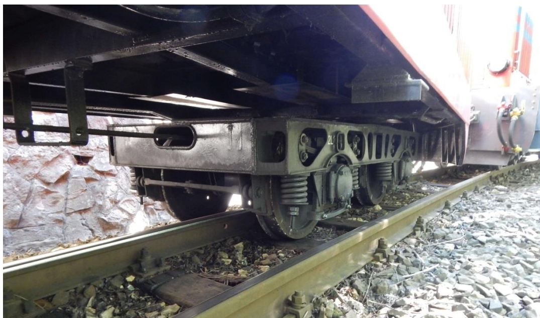
2. ábra: a kisiklott forgóváz a 2023. augusztus 14-i esetben
