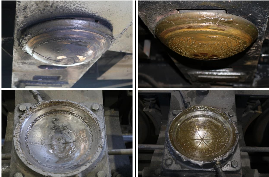
9. ábra: a kisiklott, menetirány szerinti első forgóváz forgótányérja (balra) és a sínen maradt, menetirány szerinti hátsó forgóváz forgótányérja (jobbra)
