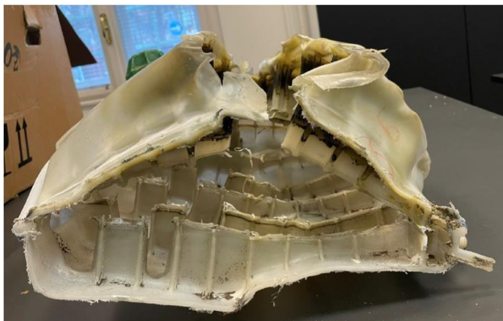
10. ábra A sérült tartály, a két fél találkozásánál megfigyelhetők a sérült hegesztések
