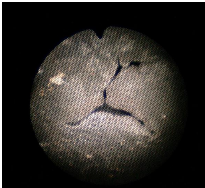
7. ábra A sérült tartály 1-es jelölésű pontjánál endoszkópos vizsgálat során készített felvétel
