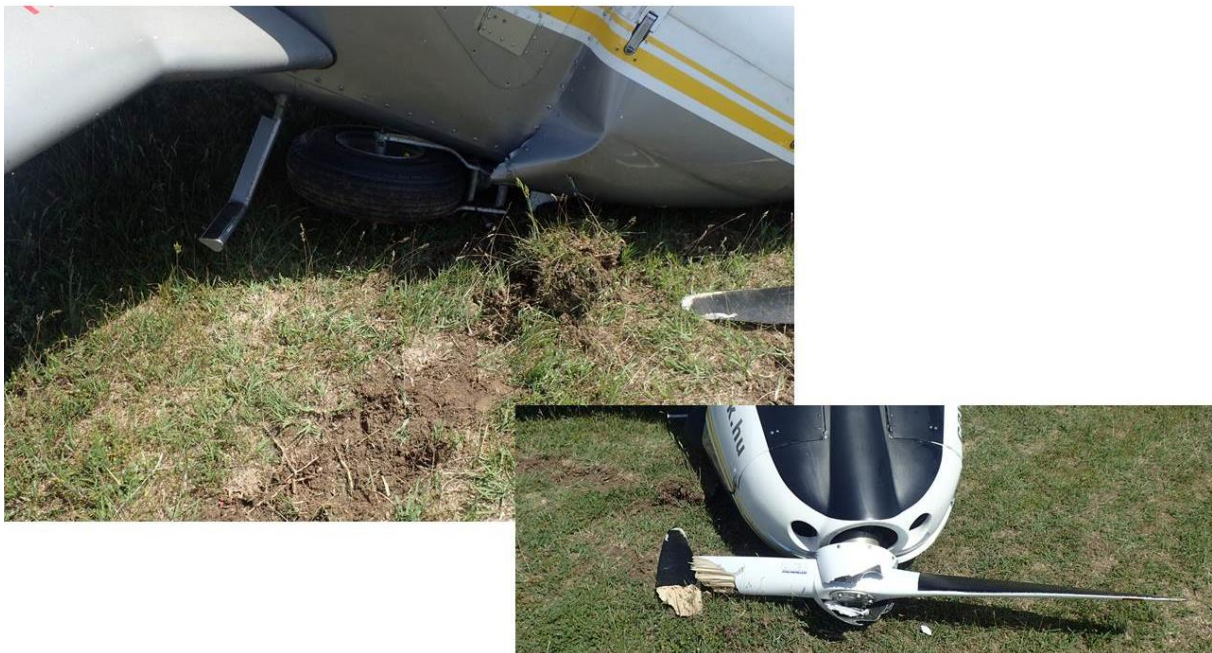
4. ábra A légijármű sérült jobb oldali borítása, törött légcsonkja és orrkúpja.
