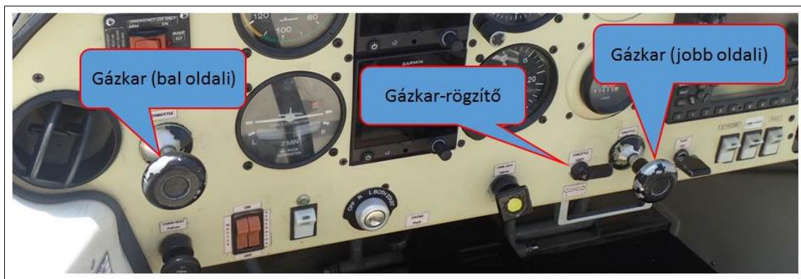
8. ábra: A gázkarok és a gázkar-rögzítő elhelyezkedése a műszerfalon
