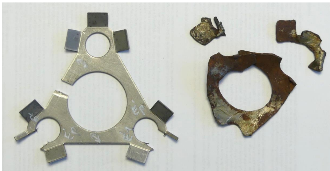
6. ábra: egy eredeti és a balesetben érintett biztosítólemez, az anyagvizsgálathoz szükséges vágások után (a korrodáltság a későbbi tisztítás következménye)
