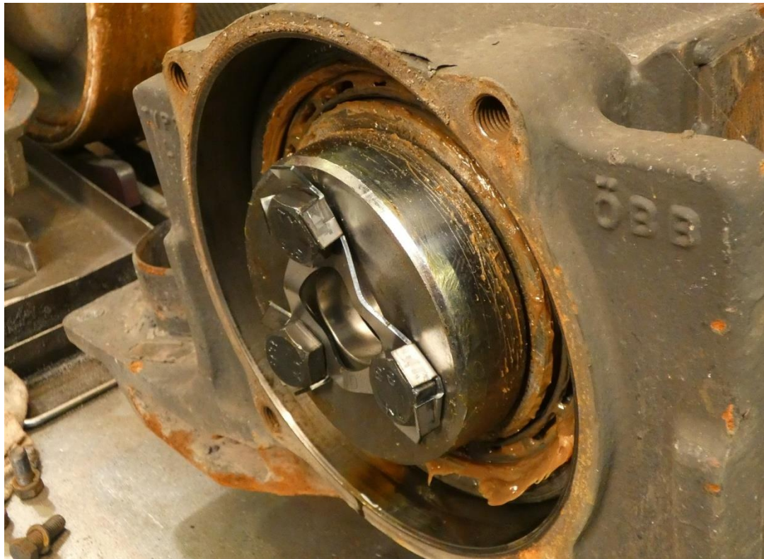
7. ábra: a sérült végtárcsa: a képen a biztosítólemez alakváltozása és a csavarok görbülete jól látható, a tárcsa homorú, palástja kúposan szétnyílt
