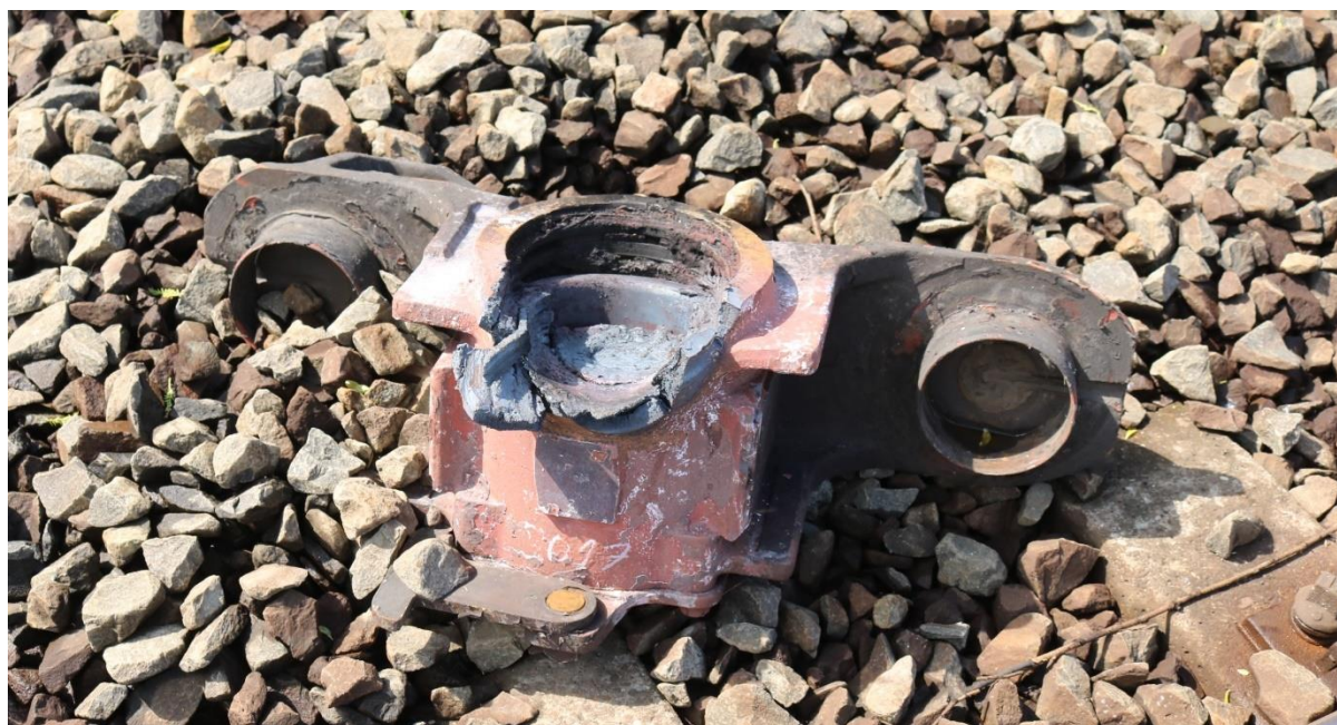
2. ábra: a leesett csapágyház
