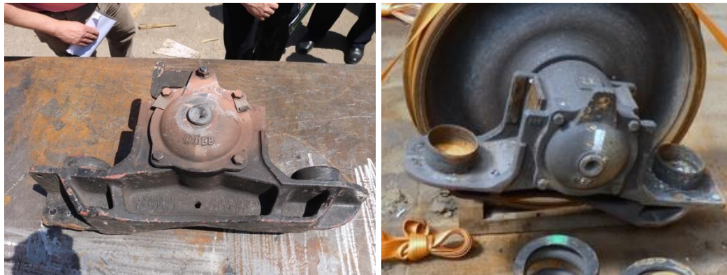
3. ábra: a sérült 2L csapágyház megbontás előtt, és a nem sérült 2R csapágyház
