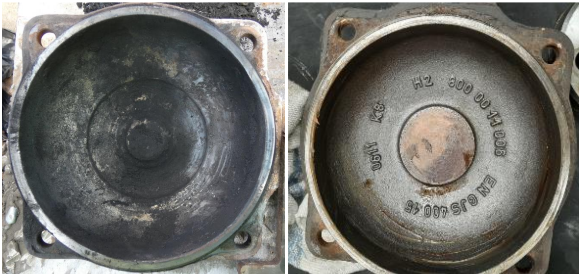
5. ábra: a sérült csapágyfedél és egy eredeti (jobb oldali kép: MÁV Zrt.)
