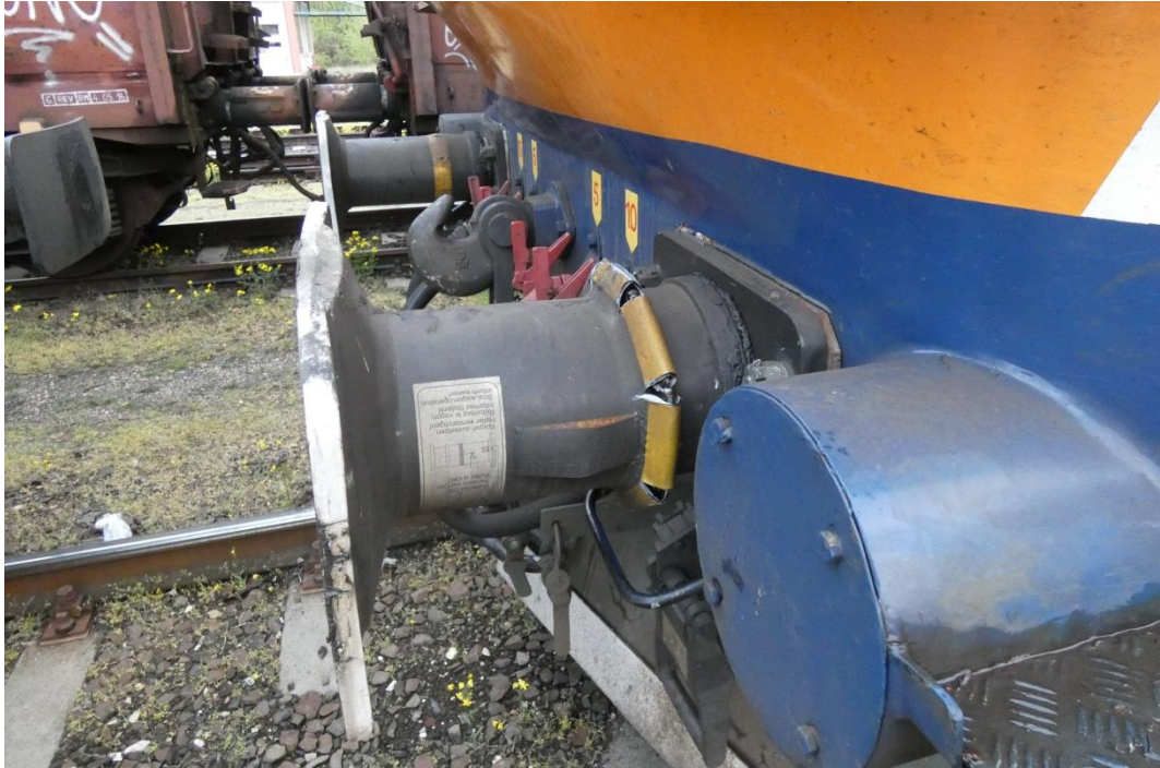
3. ábra: a törőelemnél sérült ütköző
