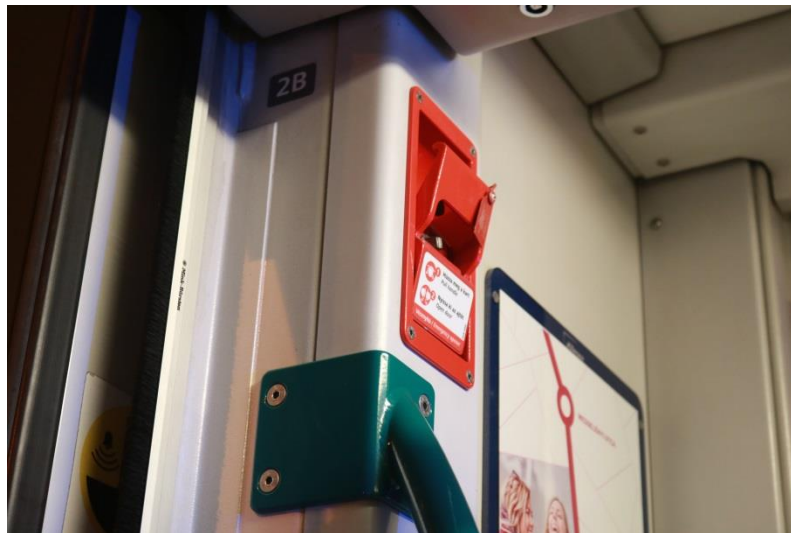
2. ábra: Működtetett vésznyitó kar a 2014 psz. villamos „2B” jelű ajtajánál
