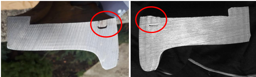
3. ábra: a ferencvárosi és vámosgyörki kisiklásokat (4.5) okozó kerékabroncsok metszetei
