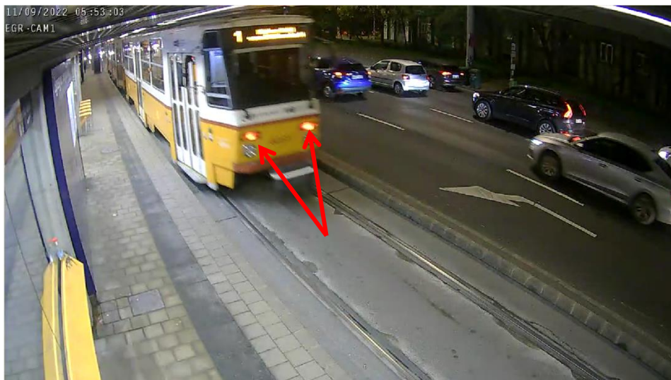
6. ábra: a balesetben érintett, elől haladó villamos szerelvény (4101-4267-4031) az Egressy út / Hungária körút megállóhelyről történő kihaladás közben (a szerelvény végén mindkét zárfény jól láthatóan világít)
