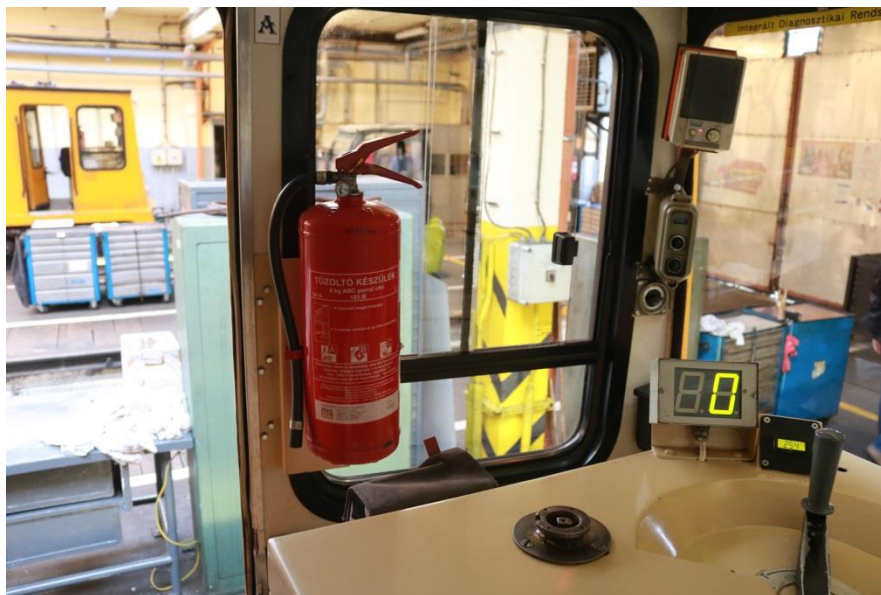
13. ábra: A tűzoltókészülék elhelyezkedése egy, az eseményben érintettel megegyező típusú MillFAV szerelvény egyik vezetőfülkéjében
