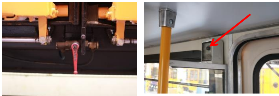
12. ábra: Légtelenítő csap a jármű alsó részén (balra) és utastéri vésznyitó gomb (jobbra)
