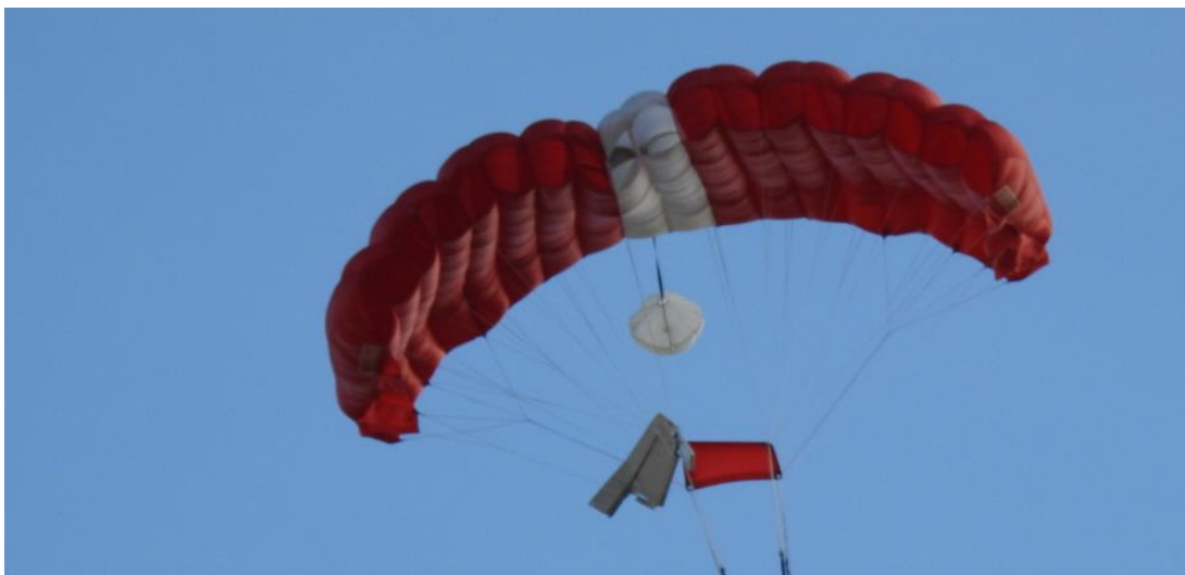
5. ábra: Az ejtőernyő zsinórzatába akadt repülőgép-alkatrész következtében részlegesen felfúvódott kupola (forrás: magánszemély)
