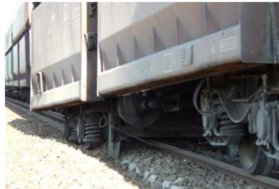
3. ábra: a 22. kocsi menetirány szerinti első forgóváza 2 tengellyel siklott
