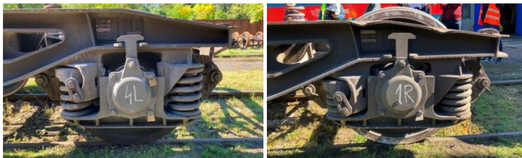
7. ábra: a teherkocsi sínen maradt forgóvázának 4L csapja (balra) és a siklott forgóvázának 1R csapja (jobbra) a kocsi alól kisserelve: látható, hogy a kisiklott 1R kerék terheletlen állapotban sem volt képes kirugózni
