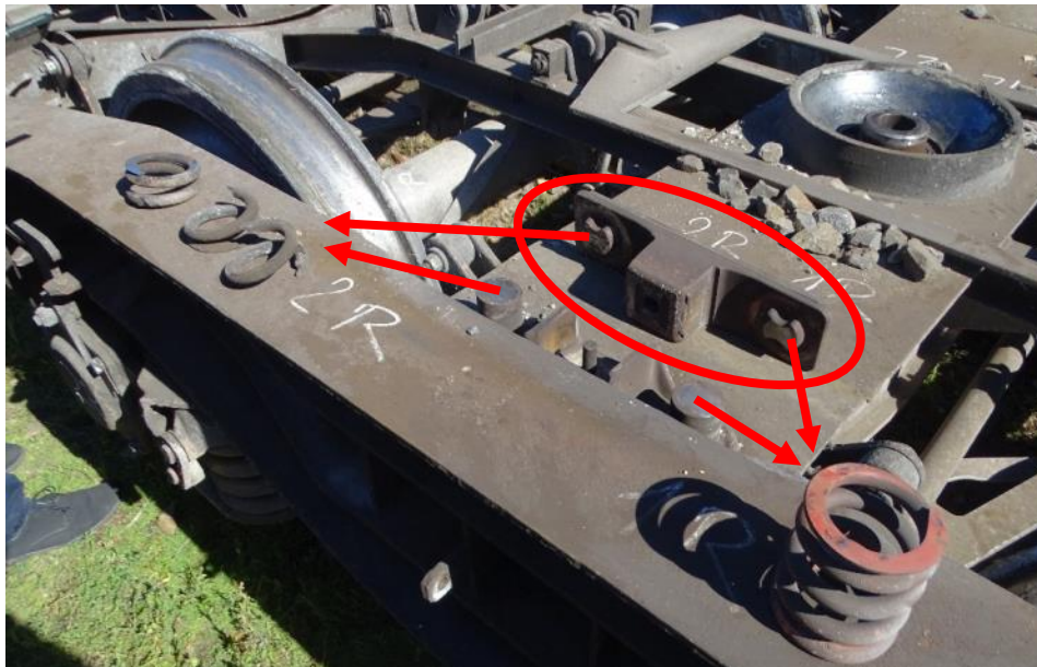
8. ábra: kiszerelt csúszótám a törött rugóival
