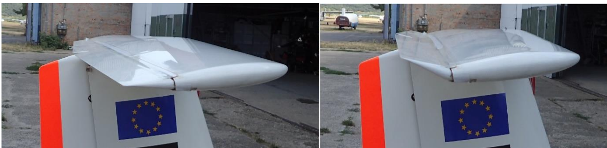
A bekötetlen (bal oldal) és a helyesen bekötött (jobb oldal) magassági kormány esetén tapasztalt maximális kormánykitérés felfelé, légerők nélkül (azonos típusú, nem a balesetben érintett repülőgépen illusztrálva).
