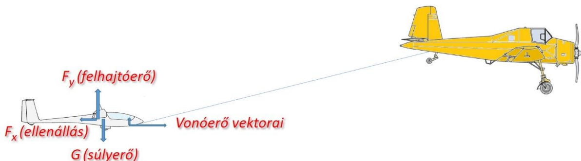
A vitorlázó-repülőgépre ható erők vontatás közben (a vontatókötél hossza nem arányosan van ábrázolva)
