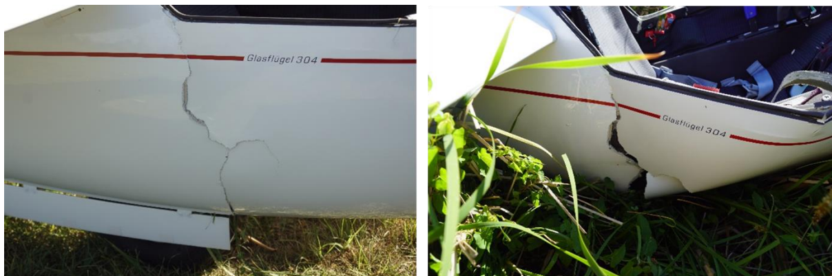
3. ábra: A légijármű törzsének sérülései
