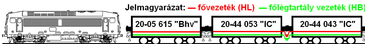
11. ábra: a szerelvény mechanikus és levegős kapcsolatai a megfutamodáskor (a megfutamodáskor a kocsikon a kézifék nem volt működtetve)
