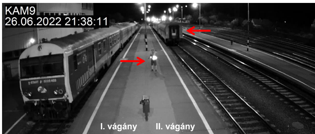
7. ábra: a 32421 sz. vonat szerelvénye a II. vágányon a végpont felé gurul, miközben az egyik kocsivizsgáló a megfutamodott kocsiknak háttal a mobiltelefonját nézi
