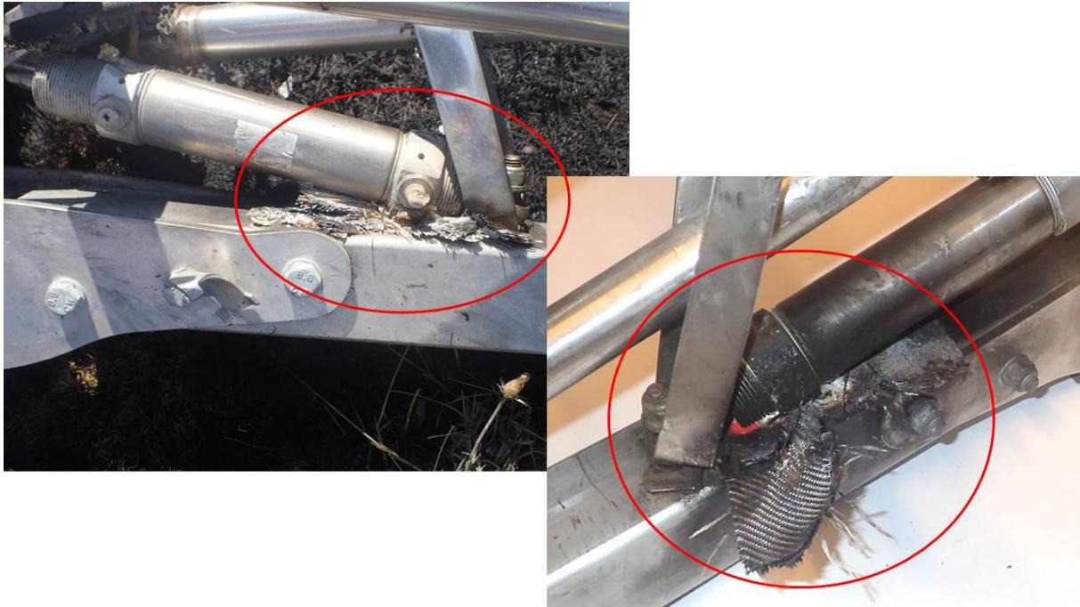
8. ábra A csillapító egység és a gerenda között a forgó légcsonk végéből származó beékelődött anyagmaradvány
