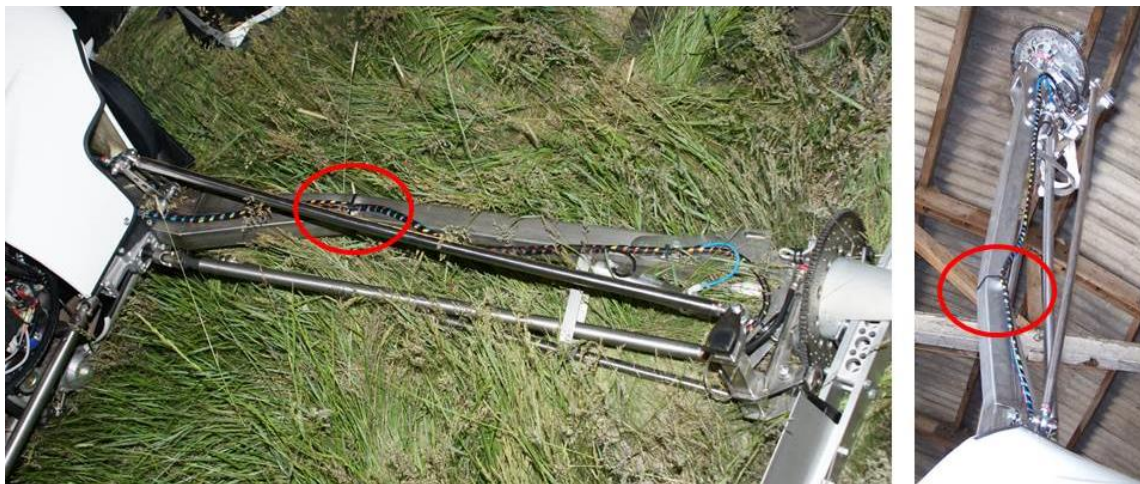
14. ábra A 2015-124-4 számon nyilvántartott eset során megsérült függőleges árbóc gerenda
