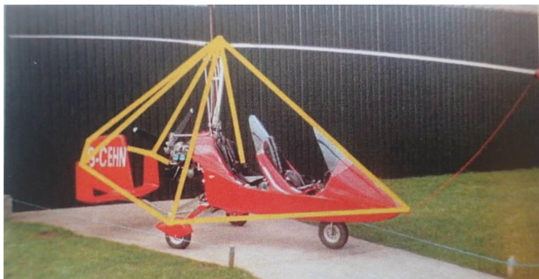
4. ábra A autogiro biztonsági rácsának szemléltetése (sárga vonalak) (Forrás: The Gyrocopter Pilot's Handbook , Phil Harwood)
