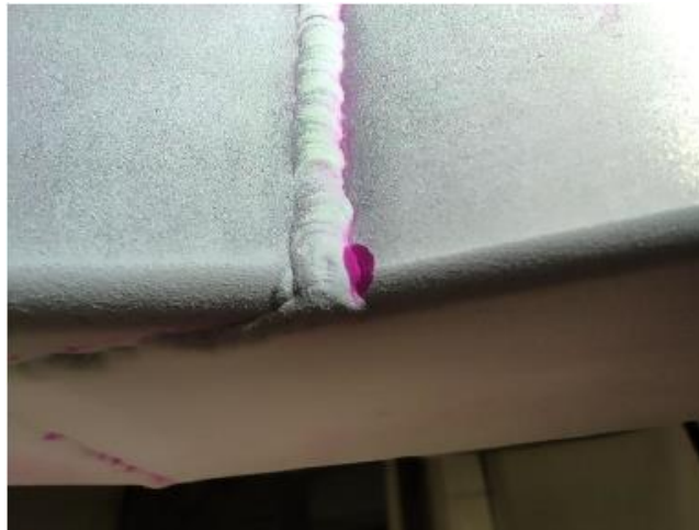
11. ábra A légijármű alap váz gerendáján lévő egyik varrat egyik sarkában talált anyagfolytonossági hiány
