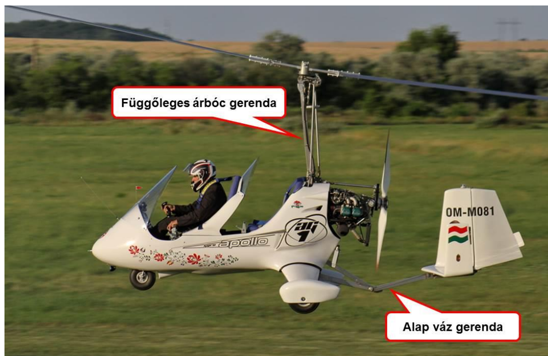
10. ábra A vizsgálatra küldött légijármű alkatrészek (Forrás: Airport-Data.com, Groszvald Attila)
