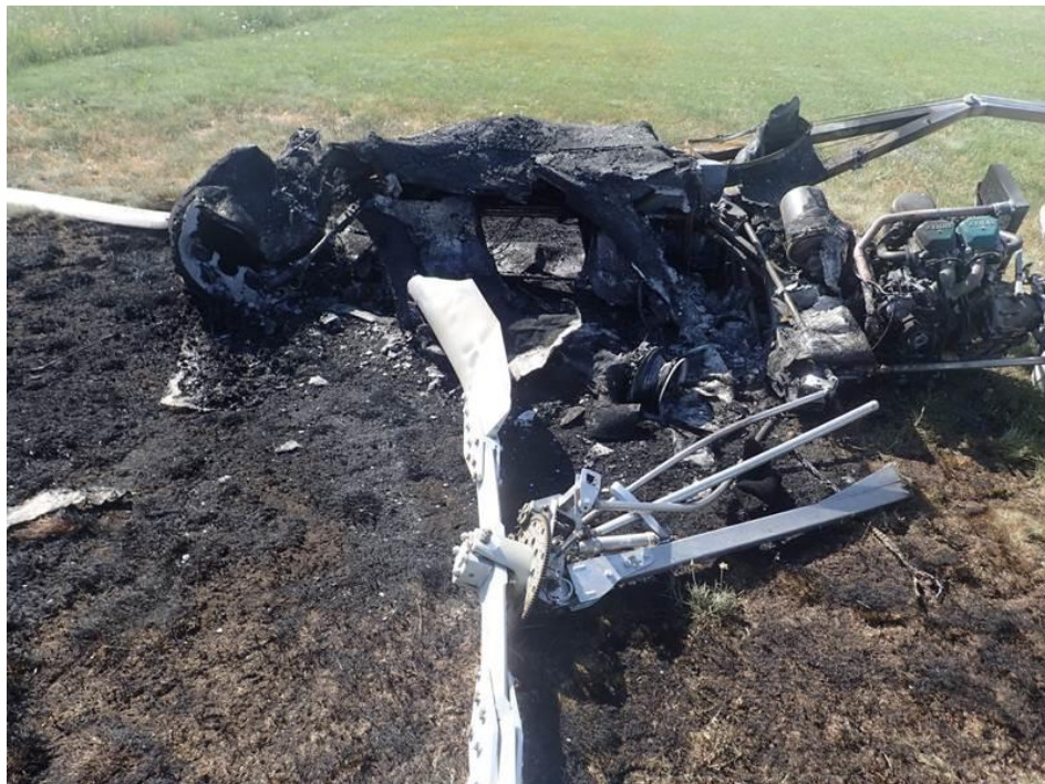
9. ábra A törött függőleges árbóc gerenda és a törzs helyzete
