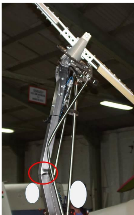
15. ábra A 2018-484-4 számon nyilvántartott eset során megsérült függőleges árbóc gerenda
