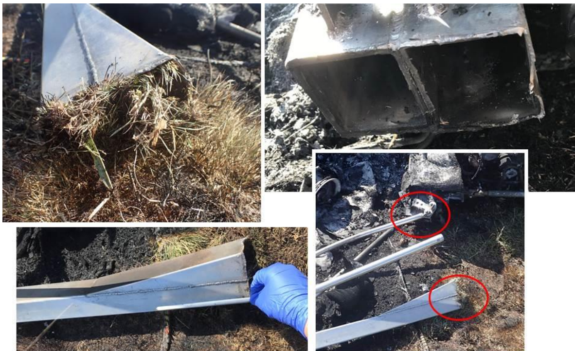
7. ábra A törött függőleges árbóc gerenda(jobbra lent), és annak felső (balra) és alsó (jobbra fent) része a helyszínen
