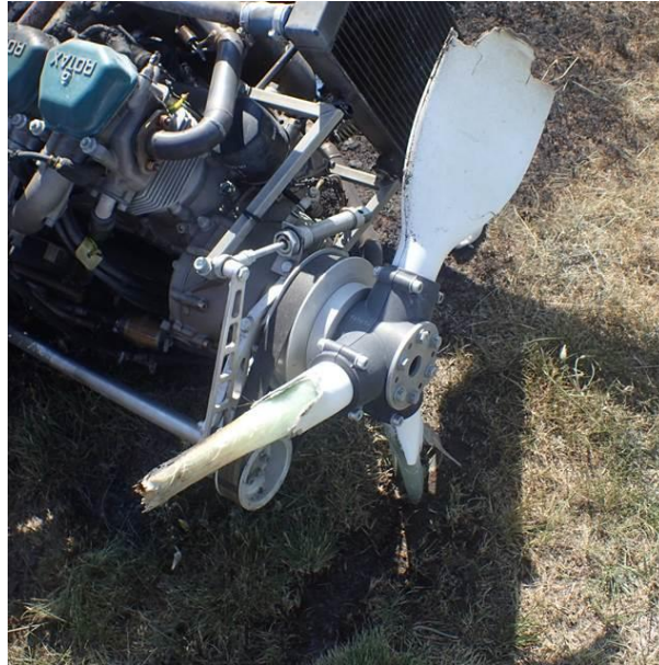
6. ábra A törött légcsavar
