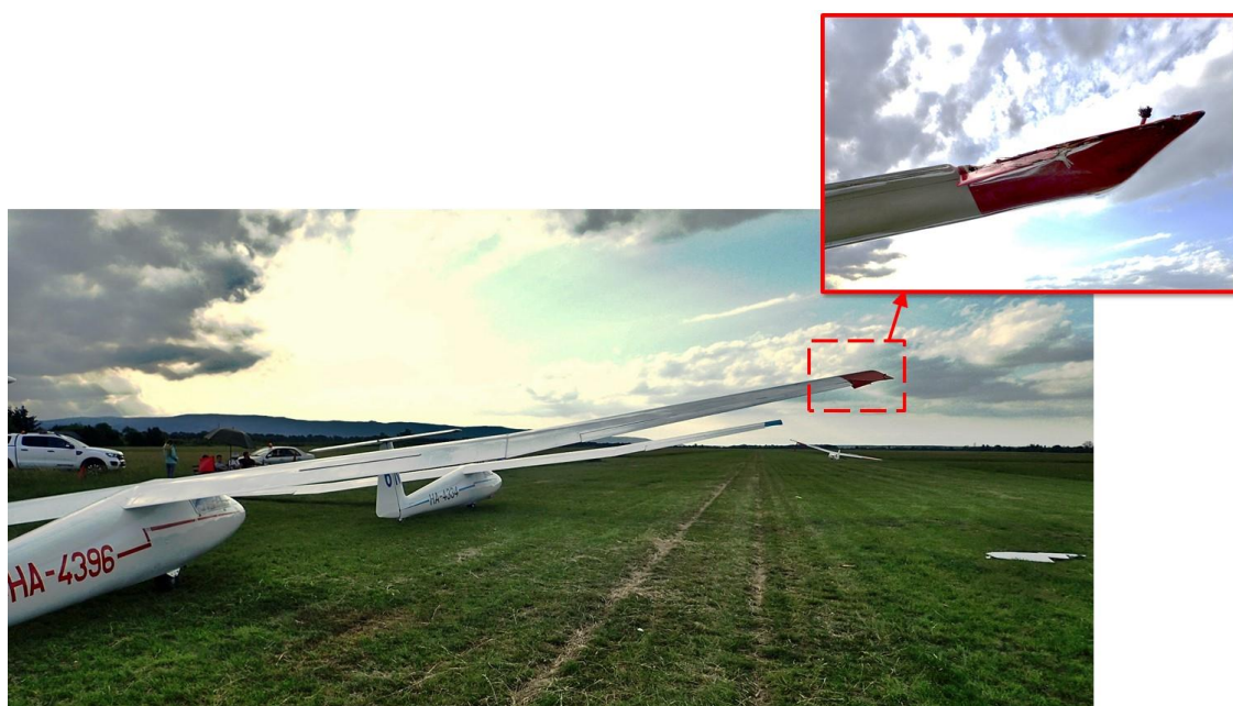
4. ábra: HA-4396 lajstromjelű, SZD-30C „Pirat” típusú légijármű sérülése
