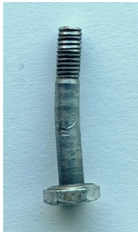
7. ábra: A sérült menetes csap
