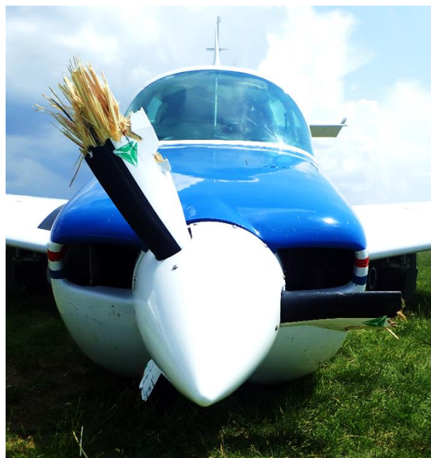
2. ábra: A repülőgép sérült légcsavarja
