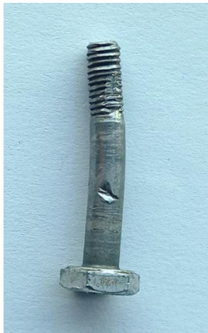
7. ábra: A sérült menetes csap
