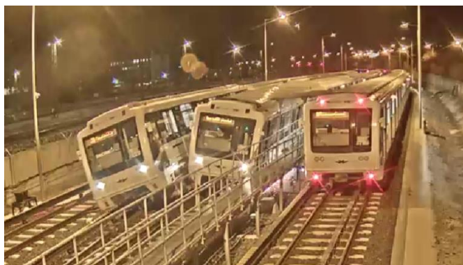
9. ábra: Az ütközéskor a kocsik jelentősen megdőltek
