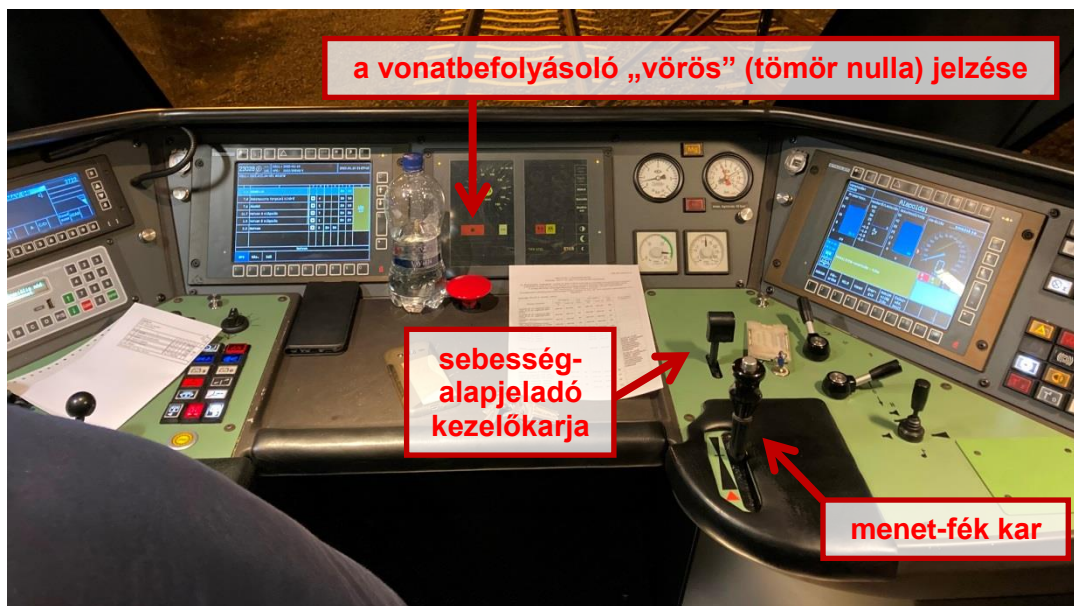
6. ábra: a 23028 sz. vonat (FLIRT) vezetőállásának kezelőszervei
