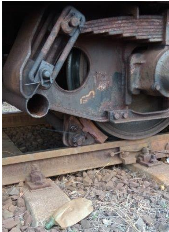
5. ábra: a 2022. február 1-én leszakadt fékszerkezet (fotó. RCH Zrt.)
