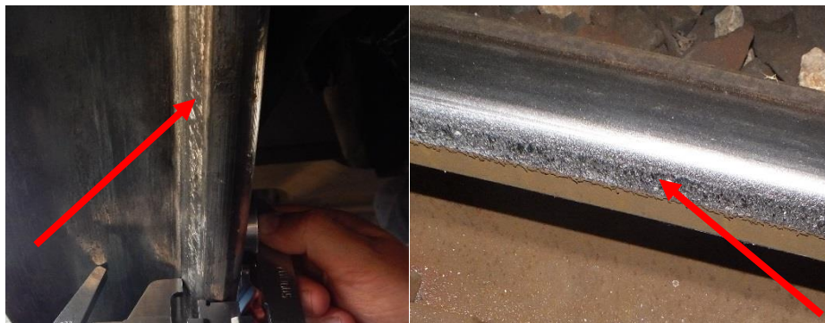
2. ábra: a felérsedetett sín és a nyomkarima
