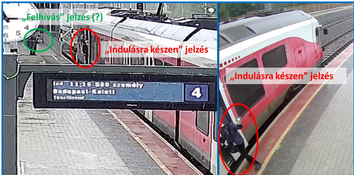
6. ábra: A jegyvizsgálók és a forgalmi szolgálattevő 11:15:38-kor, ekkor a külső forgalmi szolgálattevő szándékolatlan mozdulata „Felhívás” jelzéseként volt értelmezhető
