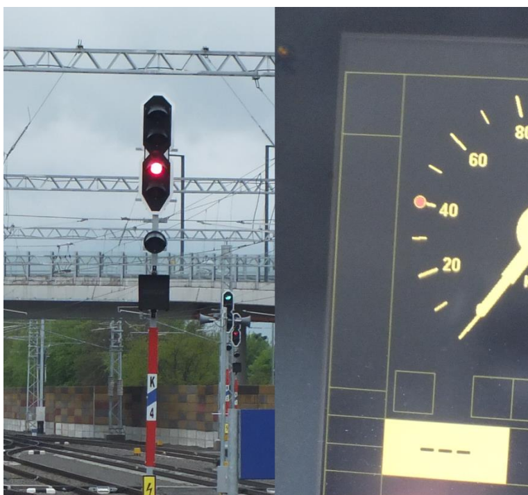
3. ábra "Megállj!" jelzést adó kijáratú jelző esetén látható jelzés a vezetőállás jelzőn, a vágányút beállítás nélkül
