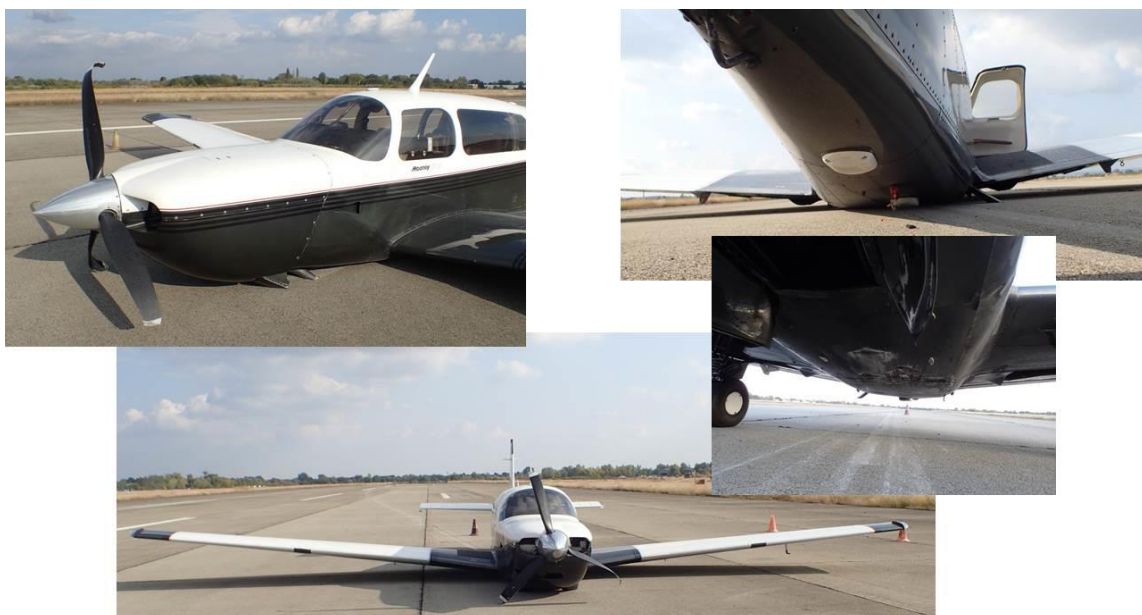
2. ábra: A légijármű látható jelentős sérülései
