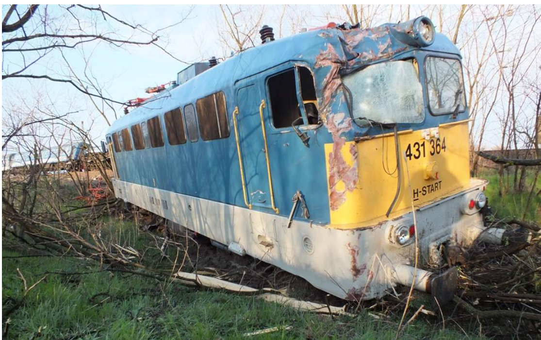
3. ábra: A mozdony rongálódása
