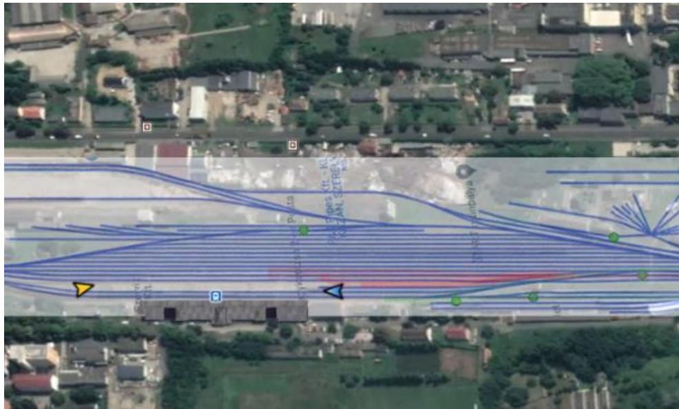
3. ábra: a mozdonyok mozgásának szimulációs részlete, a sárga nyílhegy a 855 számú vonat mozdonyát a kék nyílhegy a 8905 számú vonat mozdonyának megállás helyét ábrázolja
