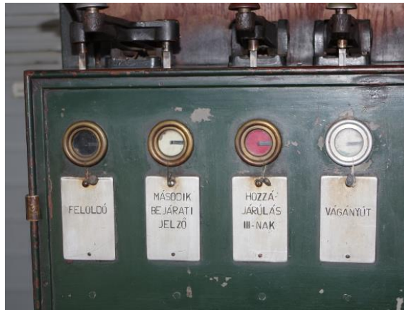
7. ábra: a blokkelemek helyzete
